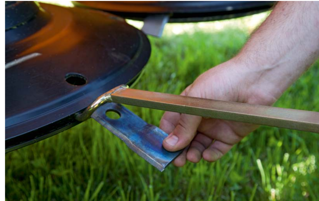
Snelwisselsysteem voor de messen
